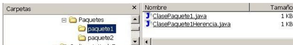
FIGURA 2: En Java, los paquetes se corresponden con una estructura de directorios
